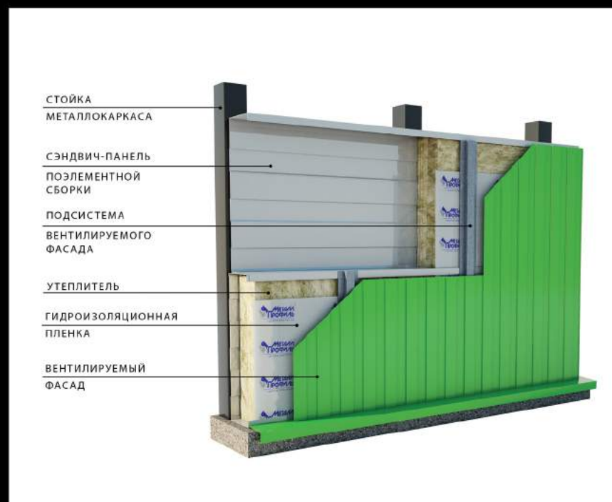
МОНТАЖ СЭНДВИЧ-ПАНЕЛЕЙ ПОЭЛЕМЕНТНОЙ СБОРКИ
