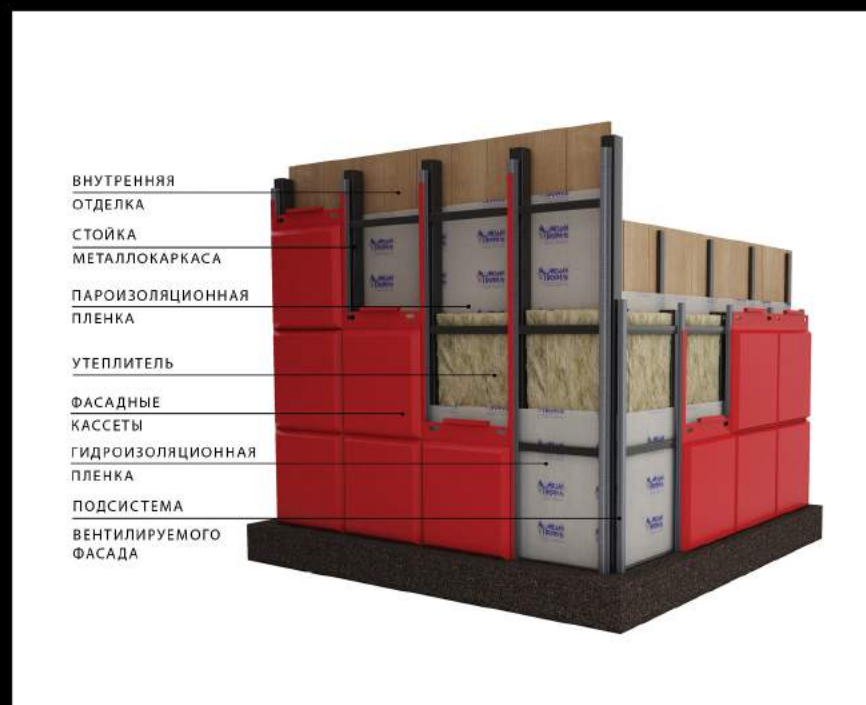
МОНТАЖ ФАСАДНЫХ КАССЕТ
