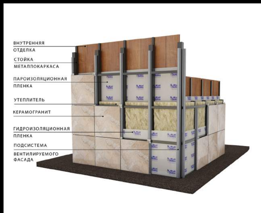
МОНТАЖ ФАСАДА ИЗ КЕРАМОГРАНИТА
