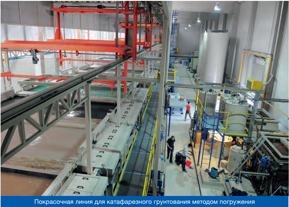
Покрасочная линия для катафорезного грунтования методом погружения
